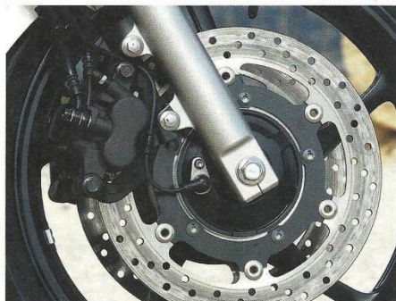
Dritte Zähne: Griffige Schwimmsättel mit schneller regelndem ABS
